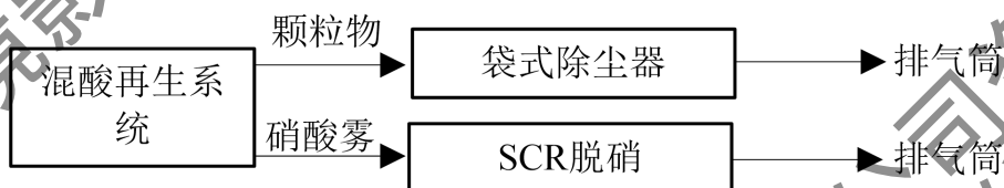
图 7.2-2 混酸系统废气处理工艺
